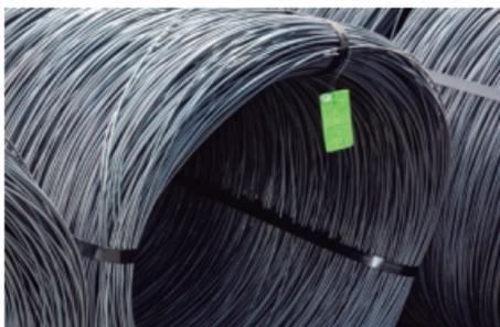
Para identificar plenamente los productos AZA, se coloca una etiqueta de alta resistencia, con toda la información del producto y su fabricación.
