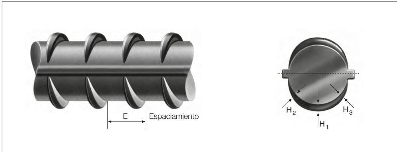
Figura 6.2.4: Esquema de Resaltes en una Barra de Refuerzo para Hormigón AZA
