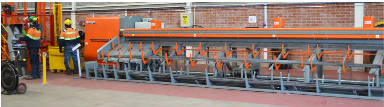
Figura 4.3.1: Máquina para el enderezado del acero en rollos.
