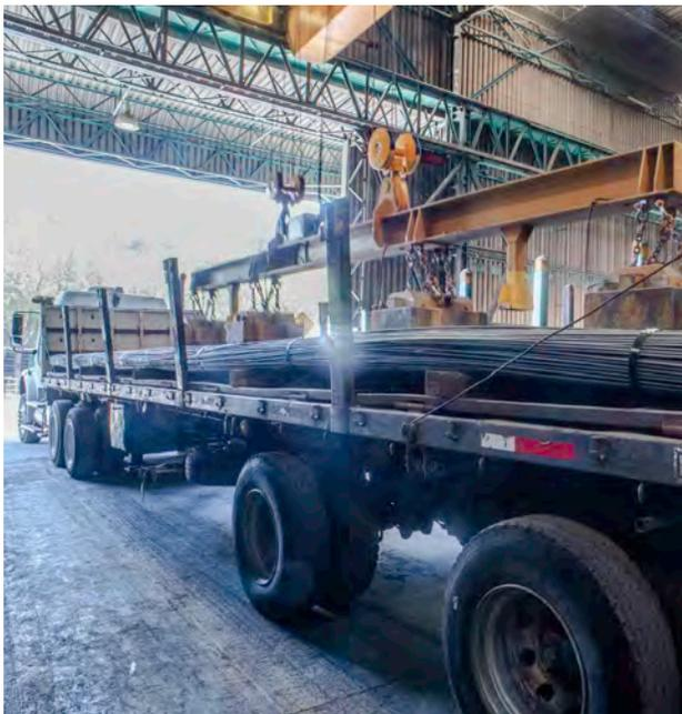
Figura 1.3.1.1: Camión rampa cargado con barras de refuerzo para hormigón.
